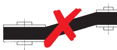
Desplazamiento axial de las poleas
