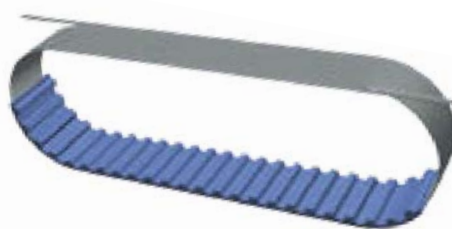
Concepto de correa sincronica optibelt ALPHA FLEX con cuerdas de tracción dual (S+Z) y poliuretano extrudido
