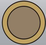
*-El templado por cementación es un tratamiento en caliente en el que se introduce componentes de la cadena en una atmósfera enriquecida con carbono.*
