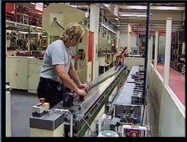
*-Las cadenas de rodillos Rexnord están **pre-estiradas** en fábrica bajo gran carga. De esta manera se reduce el alargamiento que generalmente se produce en las cadenas durante las primeras horas de trabajo.*
