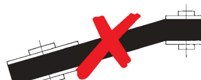
Defecto de alineación horizontal de los ejes
