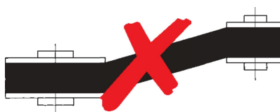
Desplazamiento axial de las poleas
