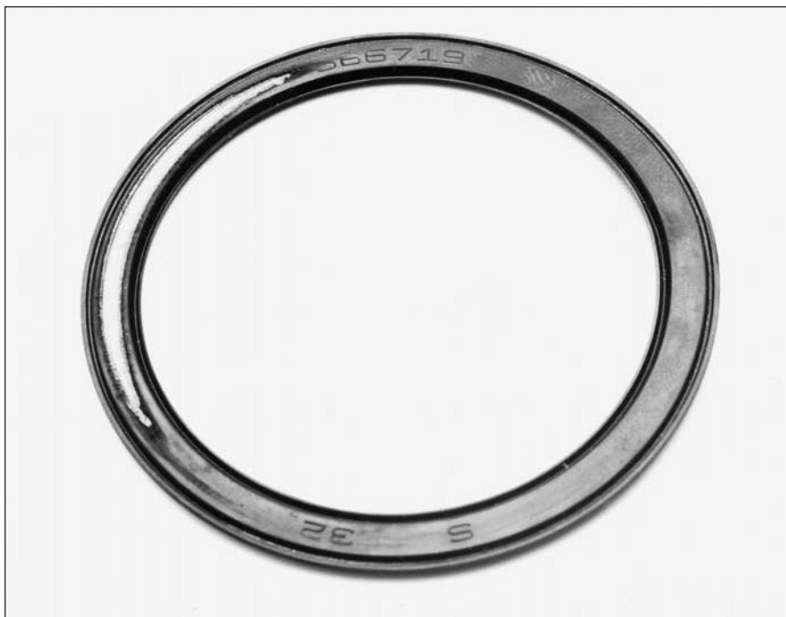
22: Deterioro de la obturación por rozamiento lateral
