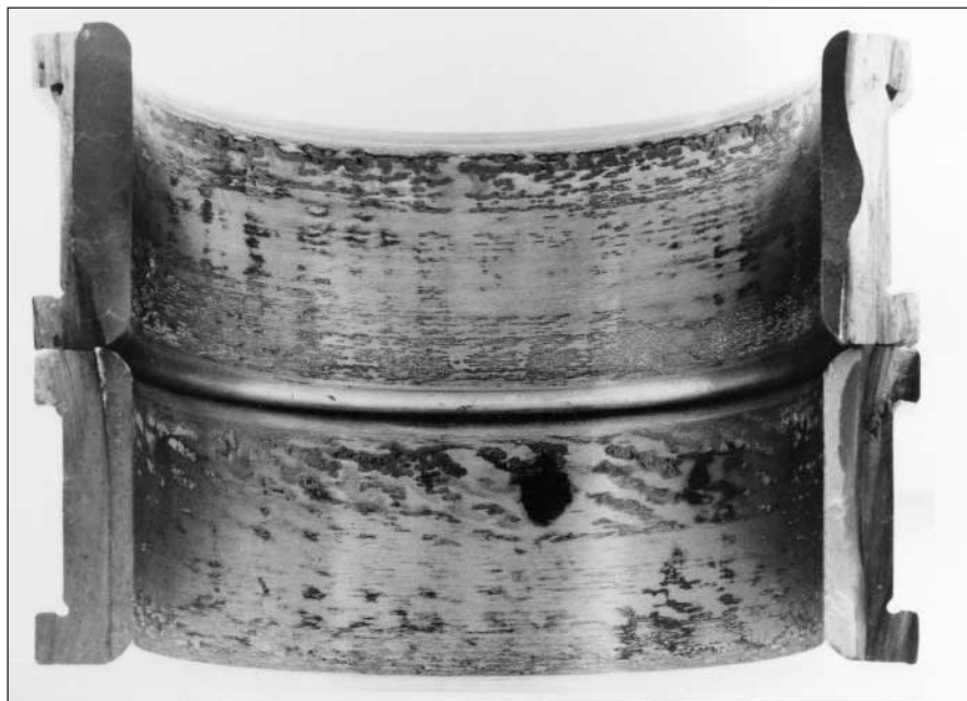
14: La oxidación en el ajuste hace visible el tamaño de la zona de carga en el aro exterior estacionario.
