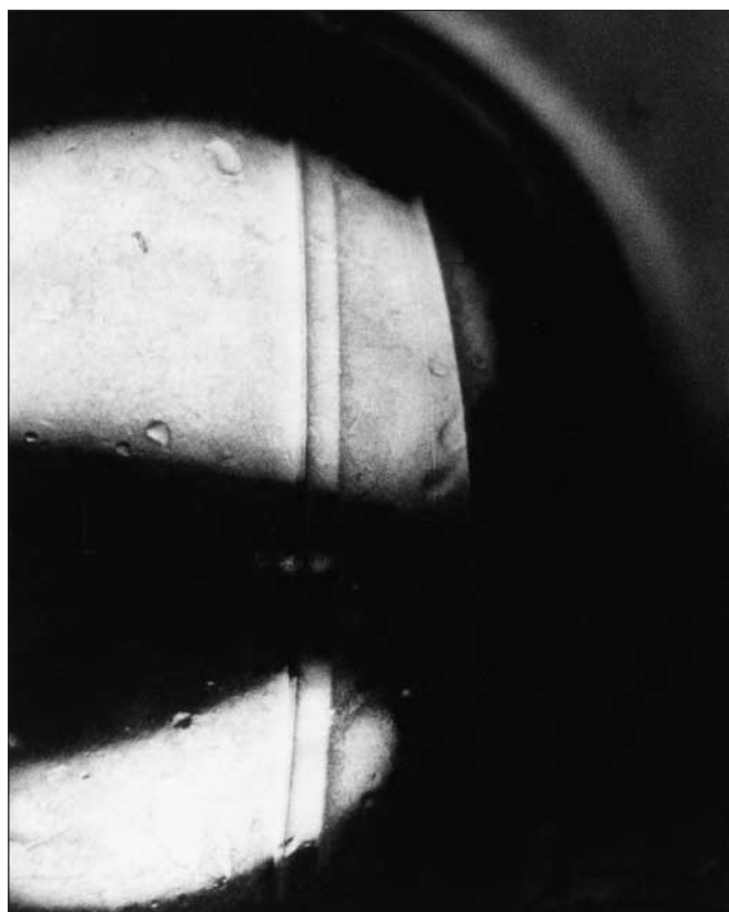
61: Bola con huellas extremas de marcha sobre los rebordes, originadas por una carga constante durante tiempo prolongado
