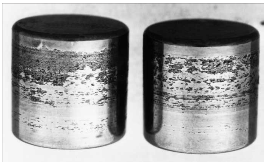
74: Huellas de deslizamiento en rodillos cilíndricos
