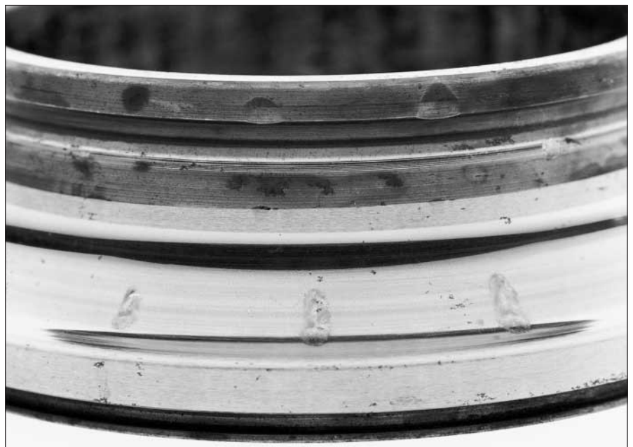
57: Falso brinelling en un rodamiento de bolas
