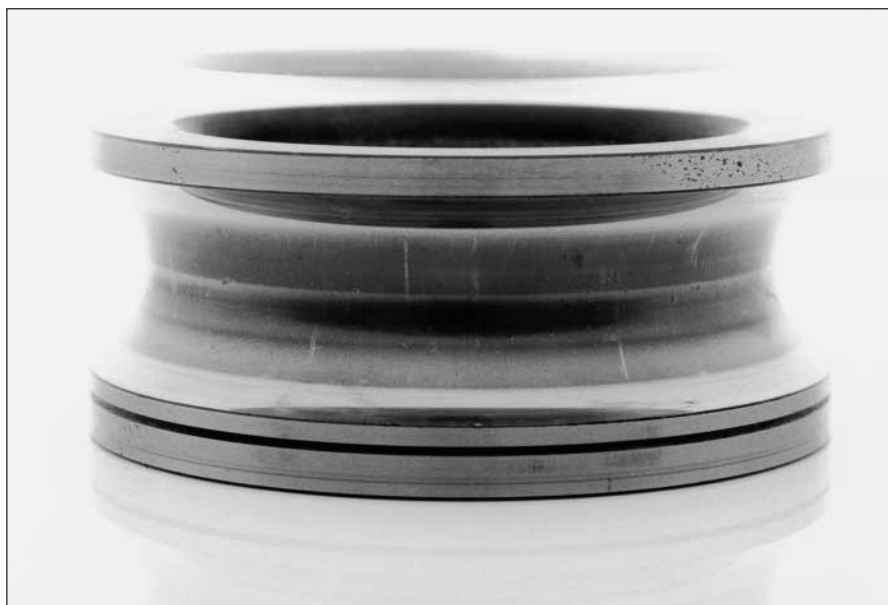
28: Huella de rodadura con desgaste superficial
