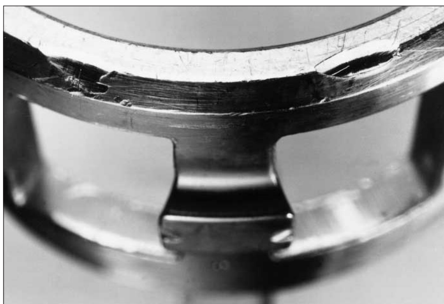
95: Jaula metálica con marcas de golpes
