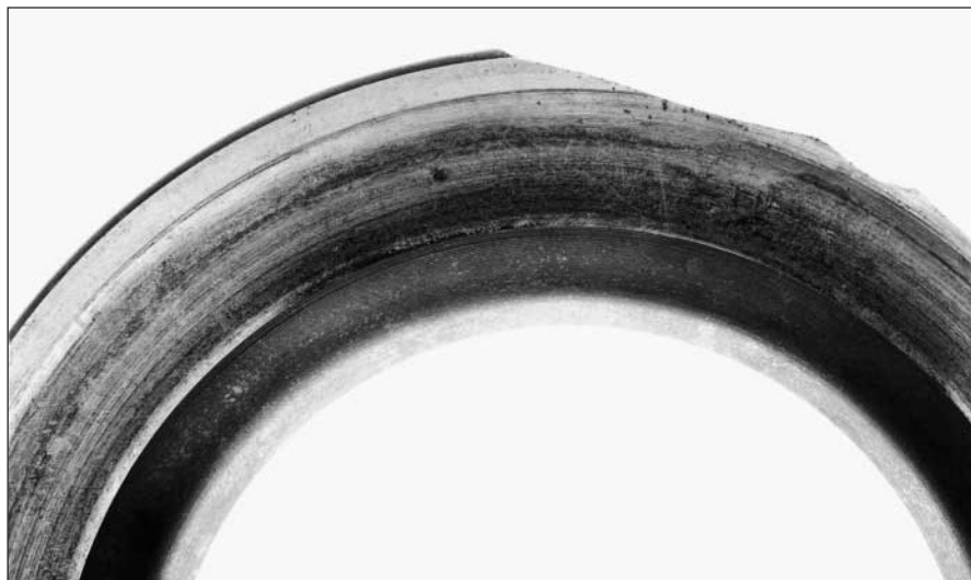
20: Rotura en el borde del aro interior de un rodamiento de rodillos cónicos a consecuencia de un apoyo axial insuficiente de la superficie frontal
