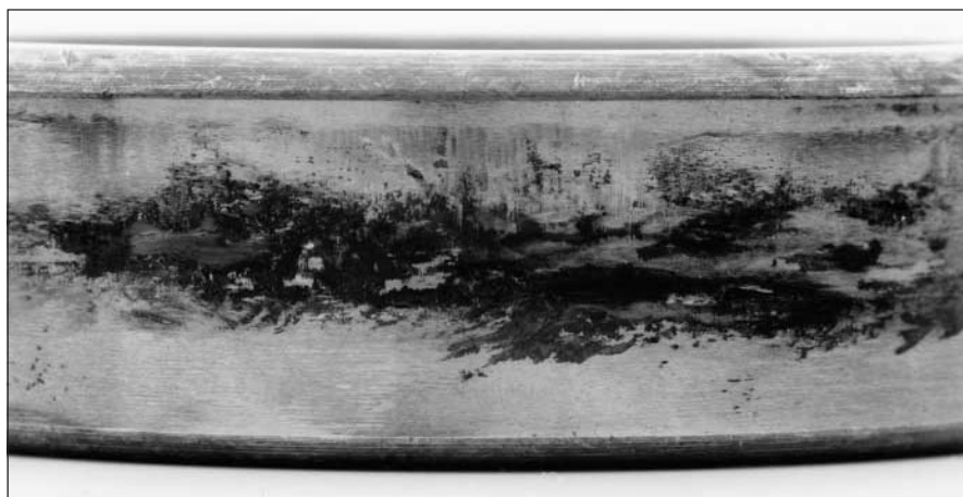
14: La oxidación en el ajuste hace visible el tamaño de la zona de carga en el aro exterior estacionario.
