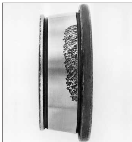
40: Huella de rodadura ladeada en un rodamiento de rodillos cónicos
