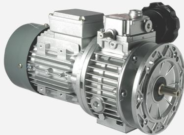
Les variateurs, série VS, sont fabriqués avec carcasse et couvercles coulés en aluminium sous pression jusqu'à la taille VS080 et en fonte pour les tailles supérieures.
