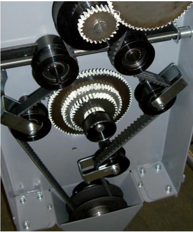
En la industria textil se utilizan distintos tipos y perfiles de correas dentadas. Ya sean correas dentadas de cloropreno como accionamiento de husillos en máquinas de texturizado, ya sean correas dentadas de alto rendimiento en grandes perfiles como transmisiones principales, o incluso correas dentadas de poliuretano, por ejemplo, piezas soldadas, de tricotasas circulares. El surtido es muy variado y las aplicaciones prácticamente ilimitadas.
