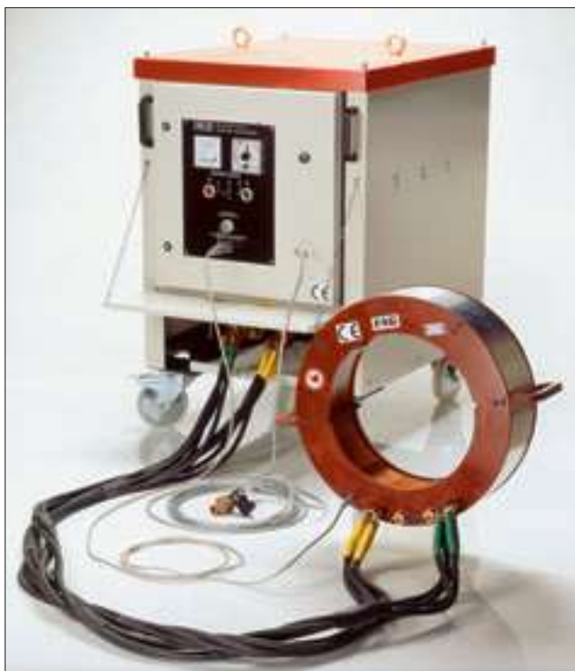
Bobina inductiva de bajo voltaje, con transformador, para desmontar aros interiores de rodamientos de rodillos cilíndricos
