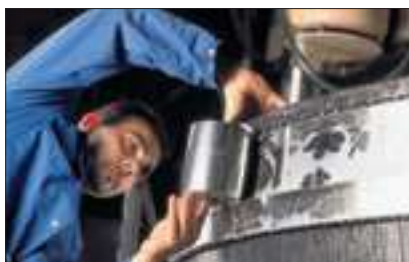
Comprobación del asiento del rodamiento
