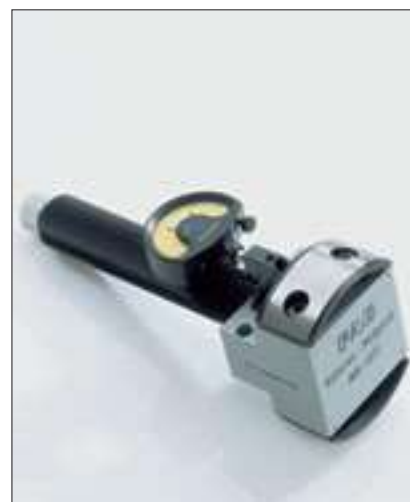
Instrumento de medición del círculo límite FAG MGI21 para ajustar el juego radial o la precarga de rodamientos de rodillos cilíndricos con aro interior desmontable.
