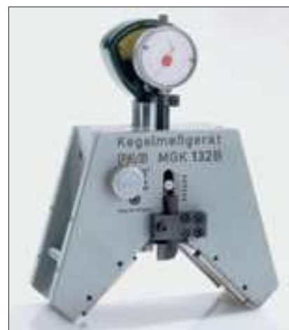
Instrumento de medición de conos FAG MGK 132
