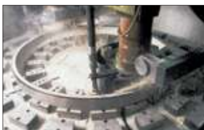
Mecanizado de un aro exterior
