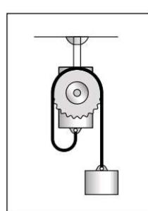
Le catene per "Trazione" trasferiscono una forza da un punto ad un altro lavorando quindi solitamente in condizioni di moto di traslazione alterno (le catene per la trasmissione invece, vengono impiegate per trasferire potenza da un'albero rotante ad un altro). La catena trazione generalmente non è chiusa ad anello. E' costituita da sole piastre e perni ribaditi.
