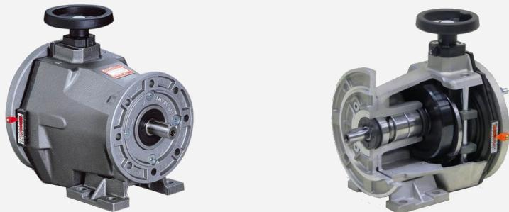
Les variateurs, type MVR permettent un réglage en continu de la vitesse dans un rapport de 5:1 sans jeux, ni vibration grâce à un déplacement du moteur sur glissières cylindriques.
